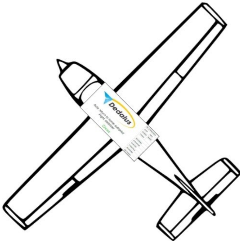
Rysunek 6 Prawidłowe umieszczenie autopilota w osiach modelu
