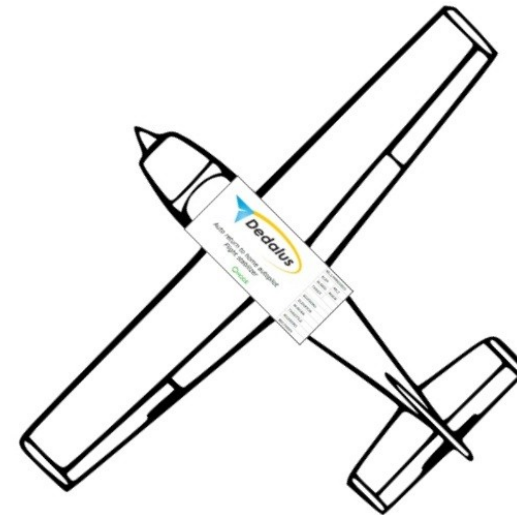
Рис. 6 Правильное расположение автопилота в модели
